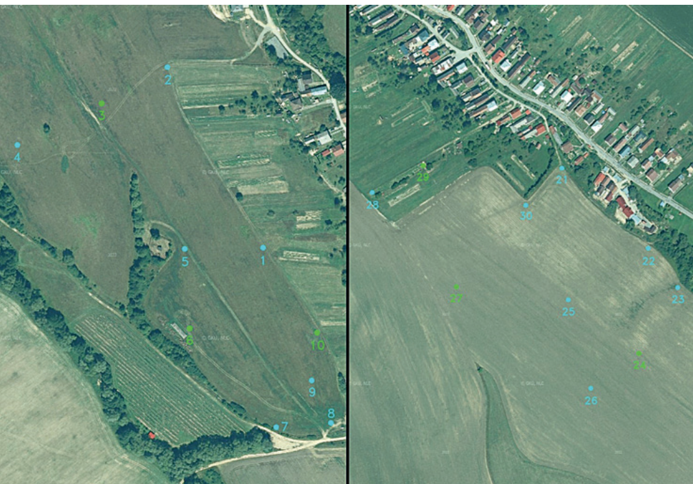
Obr. 2 • Konfigurácia GCP – modrá a CP – zelená v záujmových lokalitách Snakov_A1 (vľavo) a Snakov_A2 (vpravo)
