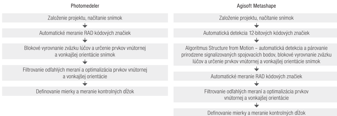
Obr. 11 • Workflow spracovania snímok pre použité softvéry – vľavo Photodeler, vpravo Agisoft Metashape
