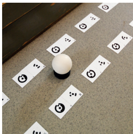
Obr. 7 • Použitie dvojice kódových značiek – vľavo: detail použitých kódových značiek spolu s imitáciou sférického terča na vloženie mierky, vpravo: rozmiestnenia kódových značiek v pravidelnom rastru
