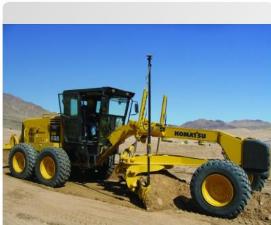
Automatická nivelácia zemných strojov
