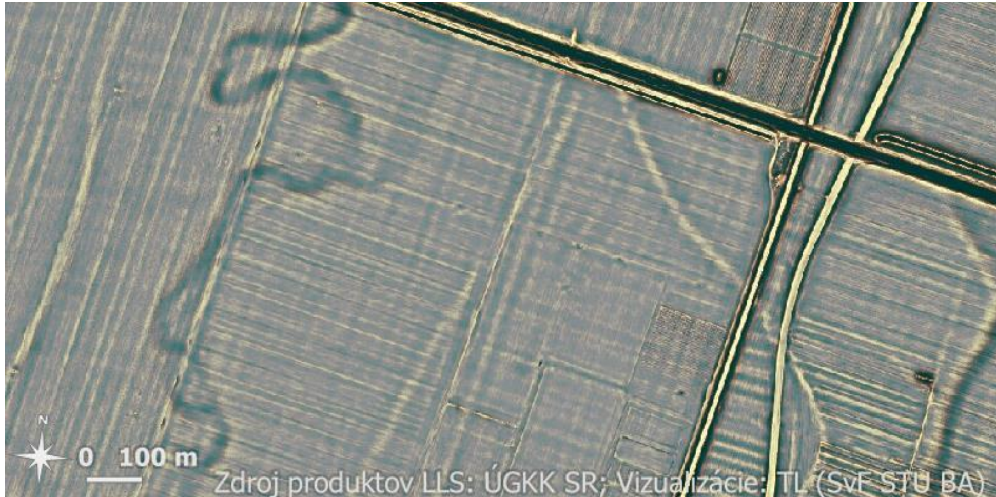
Kompozitná vizualizácia dát z LLS (KGGI SvF STU) s rozlíšením 1 m/pixel
