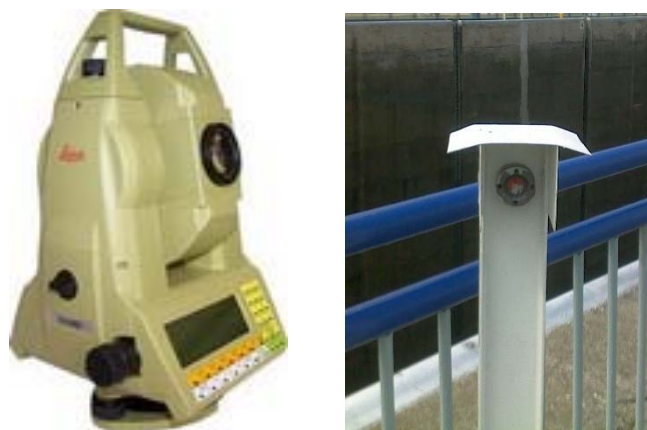
Obr. 5 Motorizovaná meracia stanica Leica TC1800 a odrazový hranol na plavebných komorách
