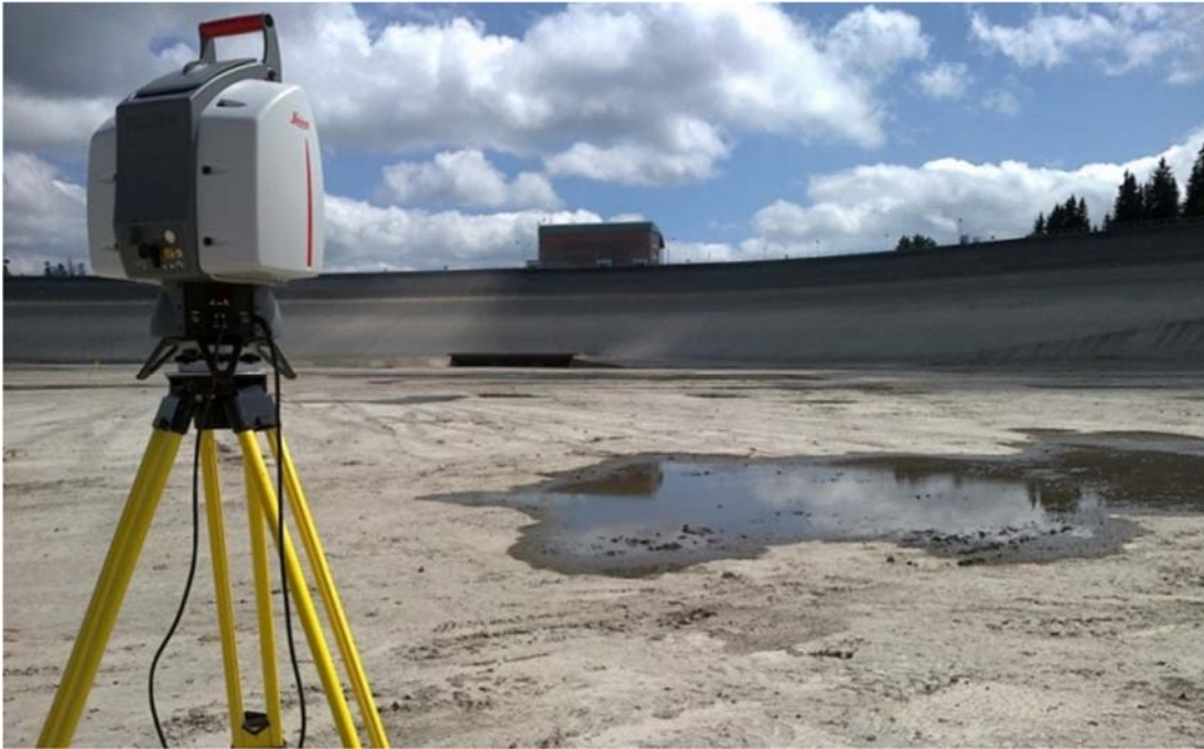
Obr. 2 Skenovanie vypustenej nádrže v roku 2012
