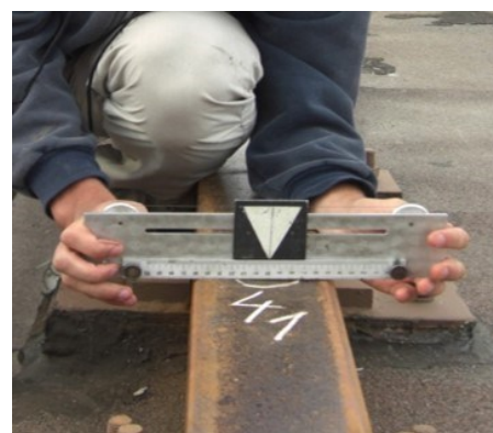
Použitie posuvného meradla s cieľovou značkou
