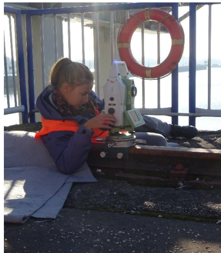
Upevnenie prístroja na špeciálnej podložke
