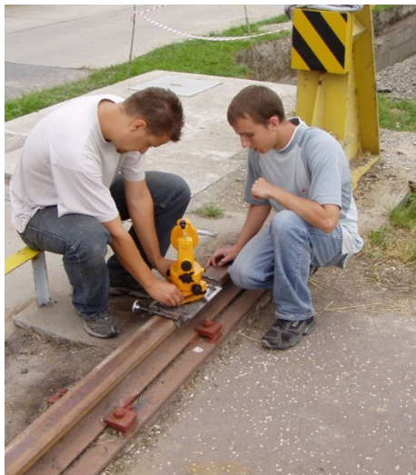
Upevnenie prístroja na špeciálnej podložke
