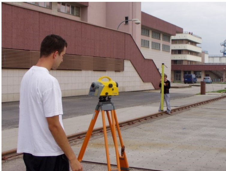
Meranie výškového priebehu koľajnicových pásov geometrickou niveláciou
