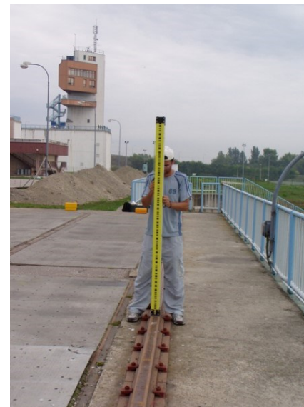
Meranie výškového priebehu koľajnicových pásov geometrickou niveláciou
